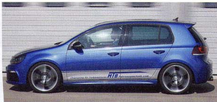
Wählerisch: Auch MTB schreibt für seinen getunten Motor den Betrieb mit 100-oktanigem Kraftstoff im Sinne optimaler Leistungsausbeute vor
