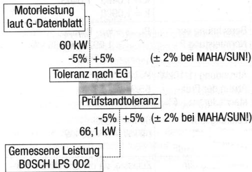
Das Messprotokoll weist eine Radleistung von 60,36 kW aus, die Temperatur der Ansaugluft betrug 44°C und der barometrische Druck 946 mbar:
